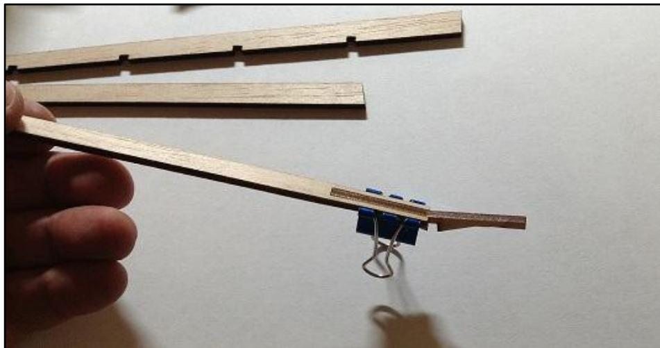
Собираем конструкцию «насухо» на чертеже и проливаем стыки kleem.
